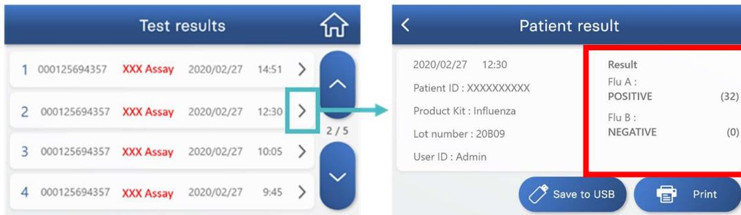
La página «Test Results» (Resultados de las pruebas) da acceso al historial de todas las pruebas, ordenadas por fecha. Para ver los detalles de una prueba concreta, pulse el símbolo «>», situado en el lado derecho.
