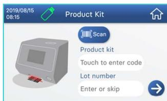
4. Escanee el código de barras que aparece en el envase del reactivo con el lector de códigos de barras situado en la parte frontal inferior del Instrumento VitaPCR™. Si tiene dificultades para escanear el código de barras, escriba la clave del producto manualmente.
